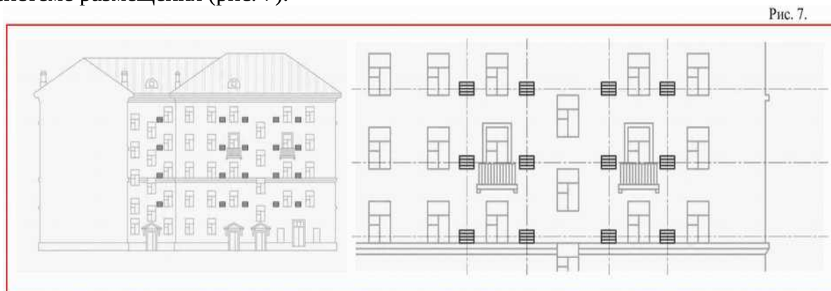
Пример правильного размещения кондиционеров на внутридворном фасаде
